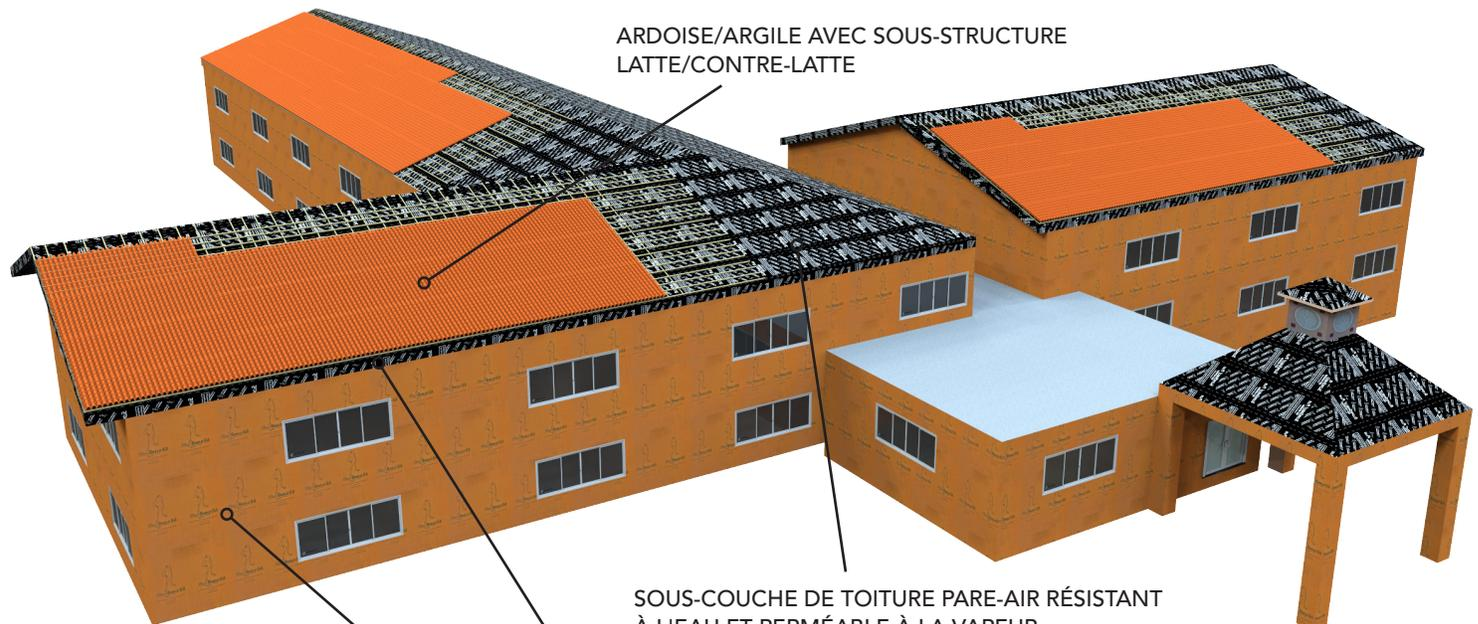
SOUS-COUCHE DE TOITURE PARE-AIR RÉSISTANT À L'EAU ET PERMÉABLE À LA VAPEUR : SLOPESHIELD PLUS SELF-ADHERED
