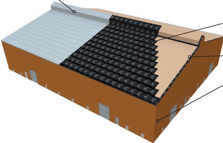
SOUS-COUCHE DE TOITURE PARE-AIR RÉSISTANT À L'EAU ET PERMÉABLE À LA VAPEUR : SLOPESHIELD PLUS SELF-ADHERED
