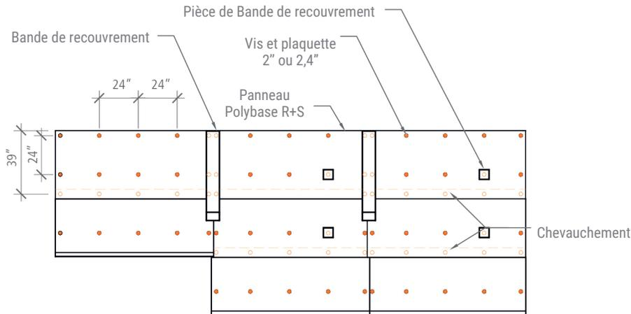
Les attaches mécaniques doivent pénétrer les pontages d'acier d'un minimum de 19 mm (3/4"), les pontages de bois de 25,4 mm (1") et les pontages de contreplaqué de 12,7 mm (1/2"). Pour les pontages en acier, l'attache doit pénétrer le pontage à la cannelure supérieure. Utiliser des rondelles de 50 mm (2") ou 60 mm (2,4") dentelées en acier selon l'application. Les attaches doivent être placées à 25,4 mm (1") minimum du bord du panneau afin d'offrir un soutien adéquat.
