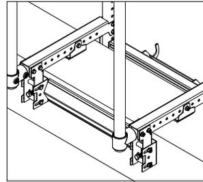
La serre ajustable et la vis d'ajustement permettent une installation précise sur le parapet.
